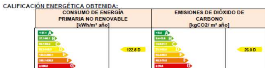
CONSUMO Y EMISIONES CON GENERACIÓN FOTOVOLTAICA
